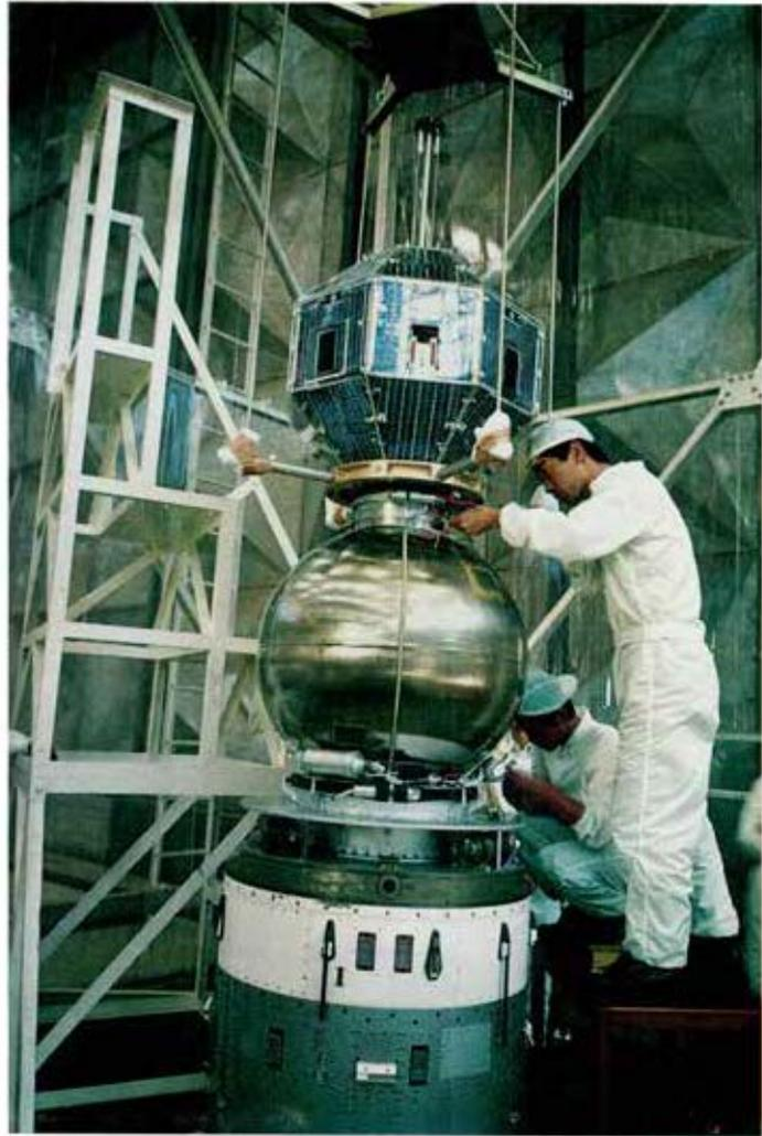
写真は上から科学衛星、第4段球型ロケット、第3段計器部と姿勢制御装置。科学衛星には多種類の観測装置がギッシリと積みまれています。
