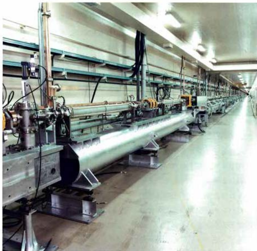
トリスタンの入射器として用いられている 2.5 GeV 電子・陽電子リニアック (全長 400 m)
