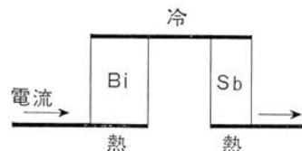
第2図 ビスマスとアンチモンによる熱電素子
