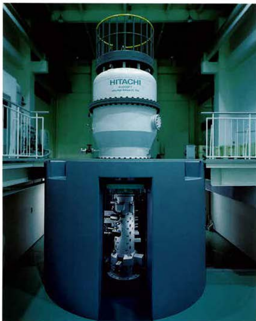
図31. 1MVホログラフィー電子顕微鏡
