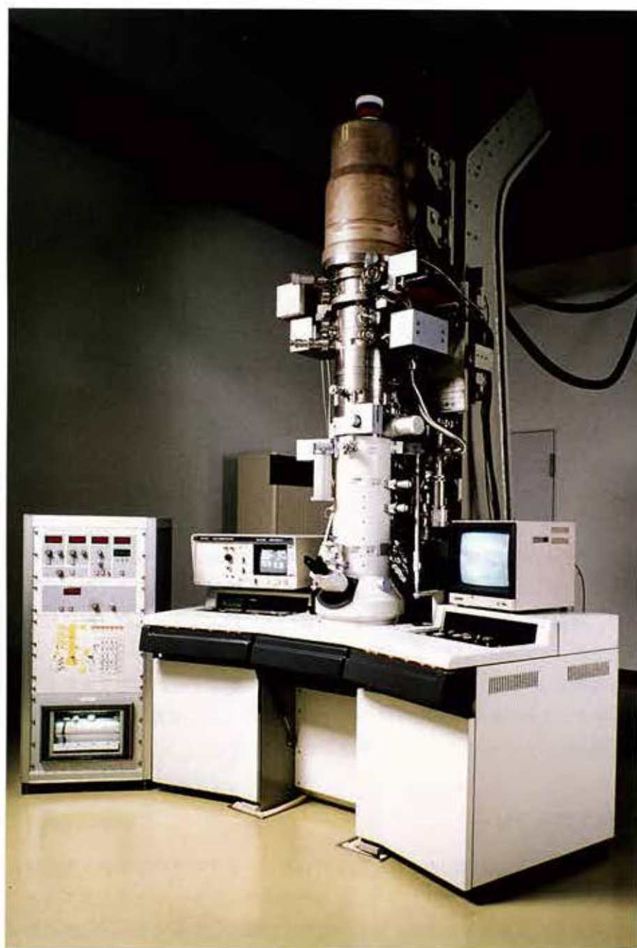
図11. 電界放出電子線を備えた電子顕微鏡
