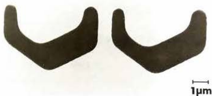
図14. 磁気バブルメモリー用の小さな磁石
