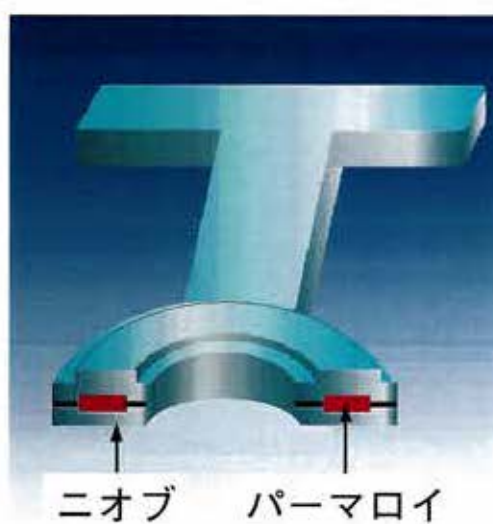
図24. 超伝導体で囲んだドーナツ状の磁石
