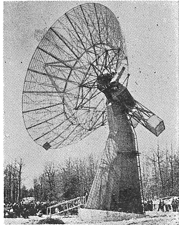
第16図 これはアメリカのハーバード大学の電波望遠鏡で、直径は18メートルあります。これは太陽というより、むしろもっと遠い天体や、銀河系の構造に主として使われています。
