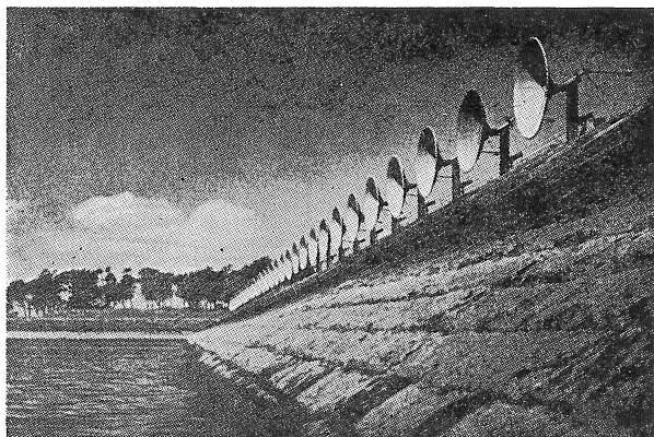
第18図 これは特殊電波望遠鏡でありまして、オーストラリアのシドニーの郊外にあります。左手は水道の貯水池であります。ここに小さな、直径2メートルの放物面鏡を東西に32個並べてあります。これですと、太陽面の非常に細かいことを、太陽面の水素ガスがどういふ活動をしているか、その活動状況の太陽面上の分布がどうであるかを知ることができます。現在はこれに、東西に32個、南北に32個をクロスするように作って観測しております。豊川市にあります名古屋大学の空電研究所では、こういう方法で東西に8個使っております。
