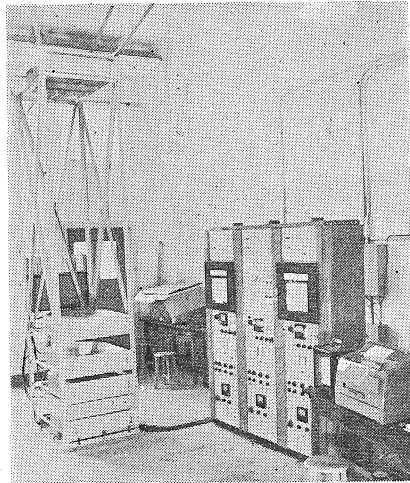
第 28 図 狭角垂直成分宇宙線計（気象研究所）。左の鉄枠がシンチレーション・カウンターの支え、右端が自動印刷装置
