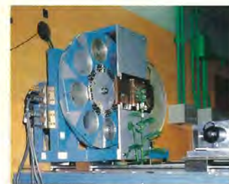
サイクロトロン生物照射室での実験の様子 写真の奥側から重粒子線が花の子房部分へ浴びせられる
