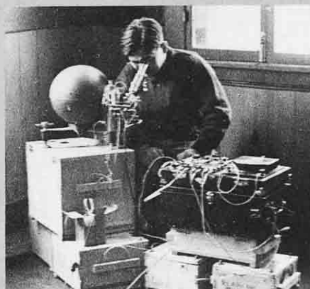
コンプトン型電離箱 日本学術振興会に 1934年宇宙線研究の ための第10小委員会ができた この装置は初期の頃から 宇宙線観測用に用いられた
