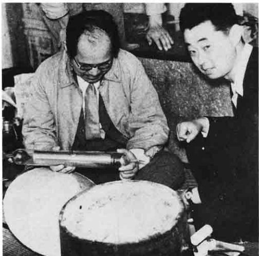
大型計数管を見ている 仁科・藤岡両博士 トンネル内における宇宙線観測用の ガイガー・ミュラー計数管
