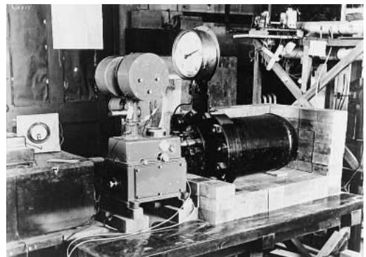
写真7 宇宙線の強度を測る仁科型電離函
