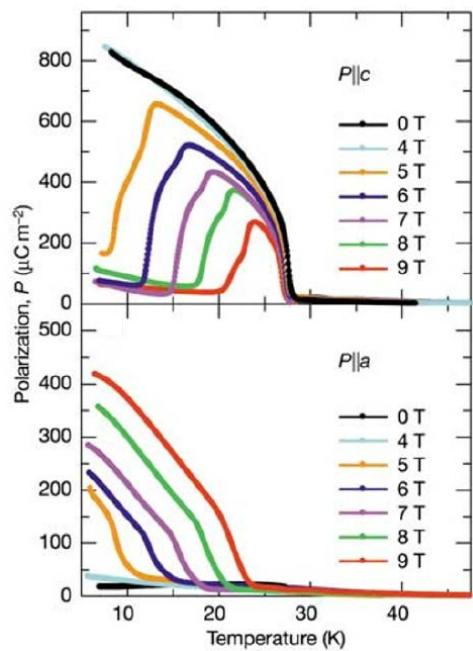
図1. ゼロ磁場およびb軸方向の磁場下における $TbMnO_3$ のc軸方向（上）およびa軸方向（下）の電気分極の温度依存性。
