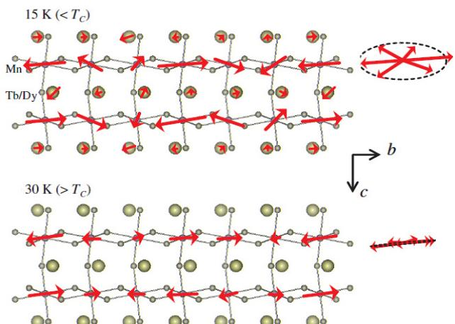
図3. Dyをドープした $TbMnO_3$ のスピン構造。 $T_c$ （強誘電転移温度）以上ではスピンの方向が同一の共線的構造を取るが（下図）、 $T_c$ 以下では非共線的サイクロイド構造を示す（上図）。
