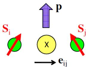
図2. 非共線的磁気構造が分極を誘起する機構。隣り合うスピン  $S_i$ 、 $S_j$  が互いに傾いた（非共線な）配置を取ると、スピン面に平行でかつ二つのスピンを結ぶベクトルに垂直な方向に電気分極  $P$  が発生する。
