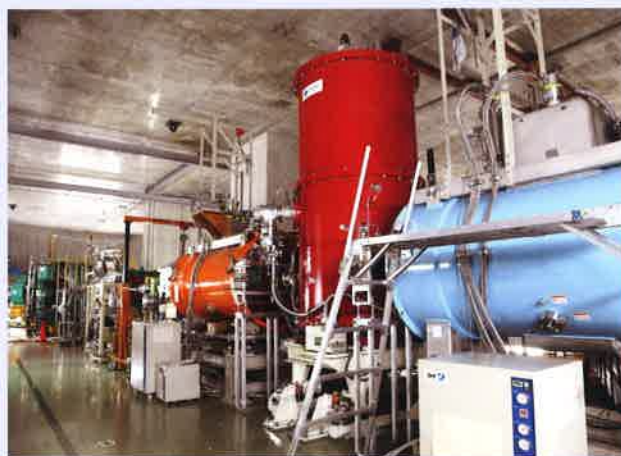
原子核科学研究センターと協力して建設したRIビーム減速・収束装置OEDO。世界初のビーム収束手法を採用している。
