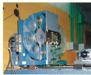
サイクロトロンで生物照射室での実験の様子 写真の奥側から重粒子線が花の子房部分へ浴びせられる
