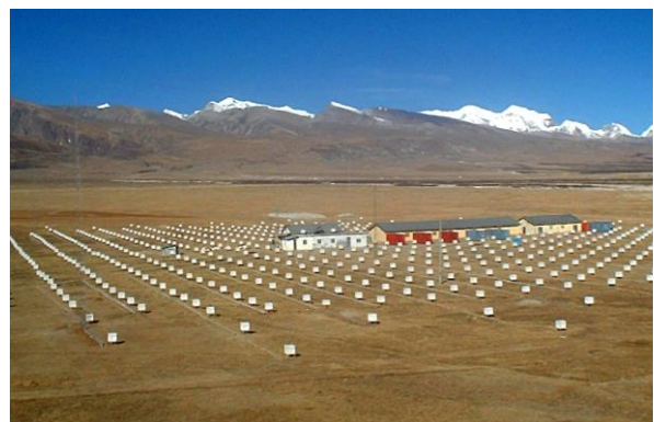
図1. Tibet AS \gamma 実験装置の地表検出器 (東京大学宇宙線研究所より)
