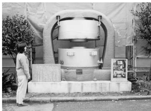
写真 第二次世界大戦後、日本で最初に作られたサイクロトロンのマグネット部分
